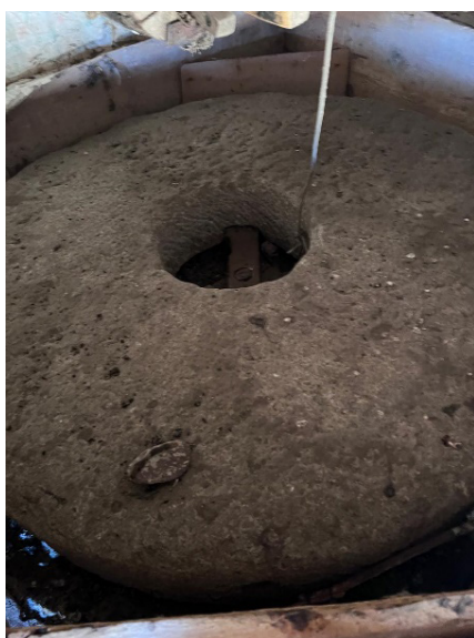
3-сурет – Судиірменнің үстіңгі тасы және тастың үстіне орналасқан астық науасы (2024 жылы шілдеде автор түсірген)
